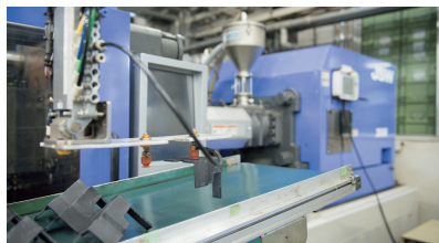
全成形機には取出機・温調機・除湿乾燥機を常設し、全自動で安定生産を行っています。
