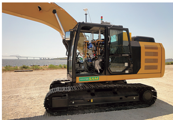
SAMを使えば建機を遠隔操作できるので、危険な場所でも作業ができる。女性や車いすの方なども工事現場への進出が可能。
