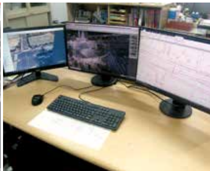
ワークステーションによる点群データ処理
