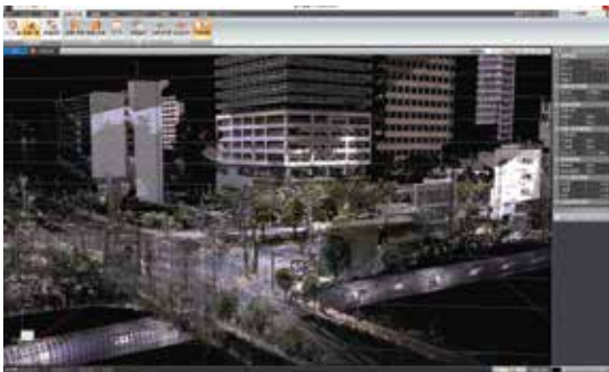
三次元レーザースカナーの屋外の点群データ
