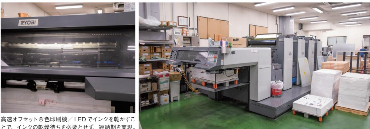
高速オフセット8色印刷機／LEDでインクを乾かすことで、インクの乾燥待ちを必要とせず、短納期を実現。
