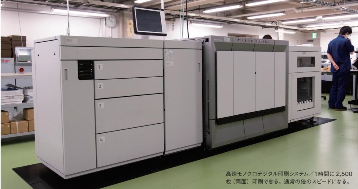
高速モノクロデジタル印刷システム／1時間に2,500枚（両面）印刷できる。通常の倍のスピードになる。
