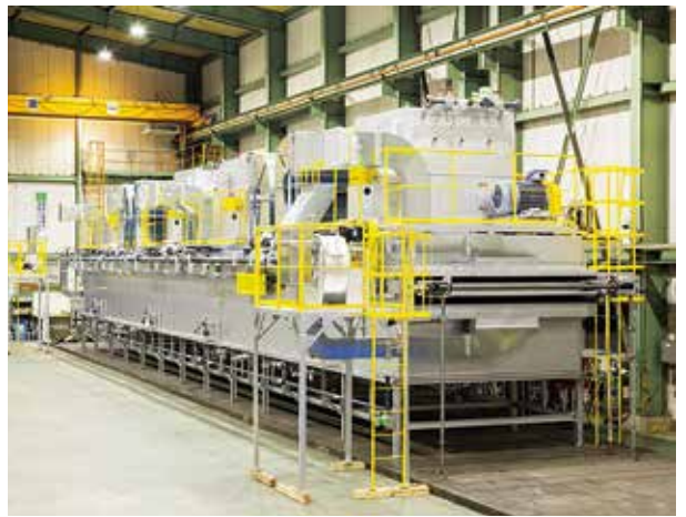
バンド乾燥機／インスタントラーメン用の乾燥機。長い機械だと50メートル以上になる。
