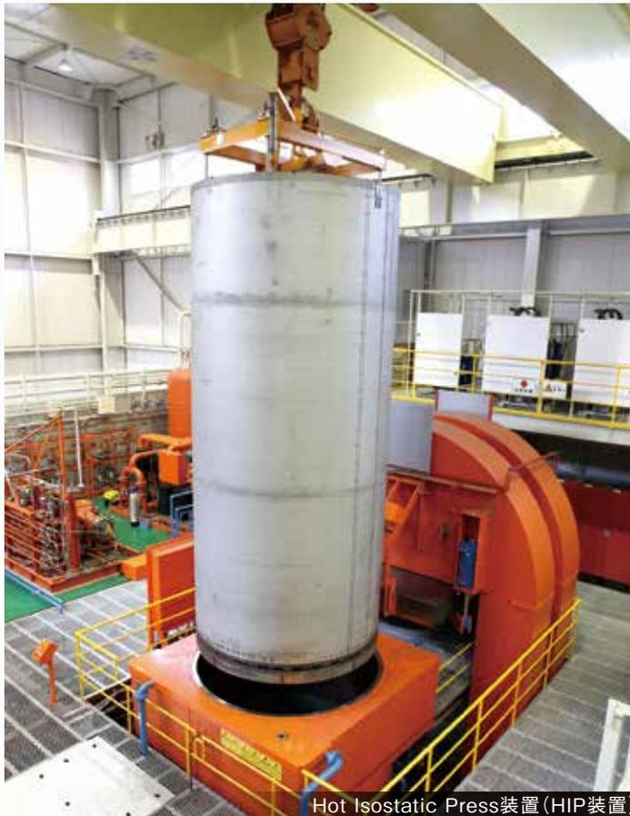
Hot Isostatic Press装置(HIP装置)
