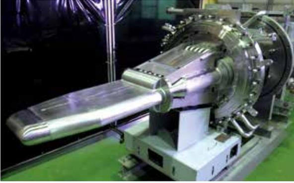
2017年9月に日本原子力研究開発機構J-PARCセンターに納入された「水銀ターゲット容器8号機」は、金属技研が2年に及ぶ設計製作期間を経て完成させた製品。2018年7月には定格出力(500kW)での計画運転を終え、無事にJ-PARCの最終目標であるビーム出力(1MW)まで上げた1時間に渡る連続運転にて、十分耐えうる性能を持つことが証明された。
